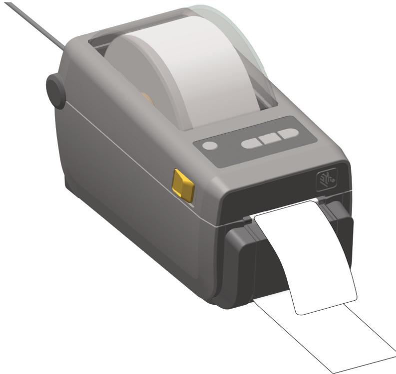
6. Pendant le travail d'impression, l'imprimante décolle le support et présente une seule étiquette. Ôtez l'étiquette de l'imprimante pour lui permettre d'imprimer la suivante. Remarque : si vous n'avez pas activé la cellule étiquette prise pour détecter le prélèvement de l'étiquette distribuée (décollée) au moyen de commandes logicielles, l'imprimante empile et éjecte les étiquettes décollées.
